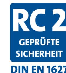
Die abgebildeten Haustüren und Seitenteile sind auf Einbruchhemmung nach DIN EN 1627 - RC 2 geprüft. Bei der Widerstandsklasse RC 2 versucht der Gelegenheitsstäter innerhalb von 3 Minuten zusätzlich mit einfachen Werkzeugen, wie Schraubendreher, Zange und Keil, das verschlossene
