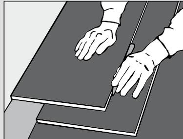
**6** Einpassen der letzten Dielenreihe: Legen Sie exakt auf die zuletzt verlegte Dielenreihe die nachzusägende Dielle. Dann zeichnen Sie mit Hilfe einer weiteren Dielen den Längsschnitt an.
