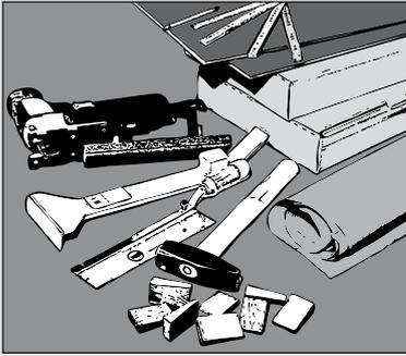
**1** Alles bereit? PE-Folie und Kleband. Als Werkzeug: Zollstock, Bleistift, Stichsäge, Fuchsschwanz, Fäustel, Setzlatte, Zugeisen, Schlagholz und Abstandskeile. Für Vinylan Hydro zusätzlich Trittschalldämmung.
