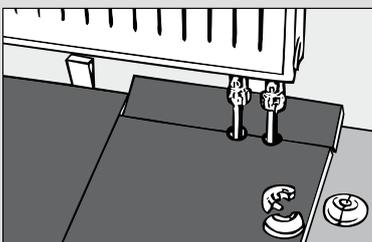
**4** Bei Heizungsrohrdurchbrüchen die Dielen am Stoß ausklinken und mit Heizkörperrosetten abdecken.
